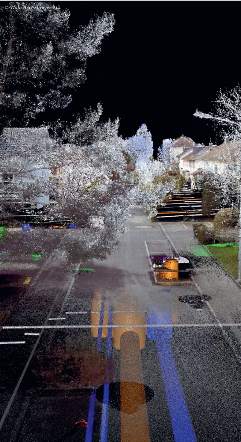
Integrierter 3-D-Scan in einem As-planned-Modell
